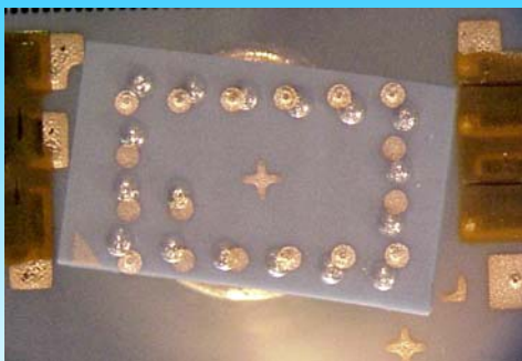
Verdreht platziertes BGA-Board vor Reflow
